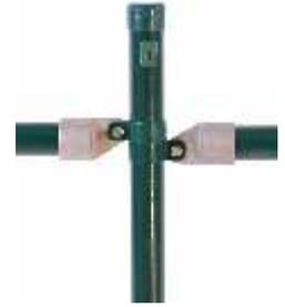
**Doppelstreben werden an Ecken, oder bei langen Zaunstrecken nach ca. 25 m eingebaut. Brücken werden waagerecht zwischen den Pfosten montiert, immer dort, wo der Pfostenabstand für Streben zu gering ist. Beispiel: Zaunstrecke 300 cm, ein Pfosten in der Mitte ergibt zwei Felder von 150 cm, es werden zwei Brücken von ca. 150 cm Länge benötigt.**
